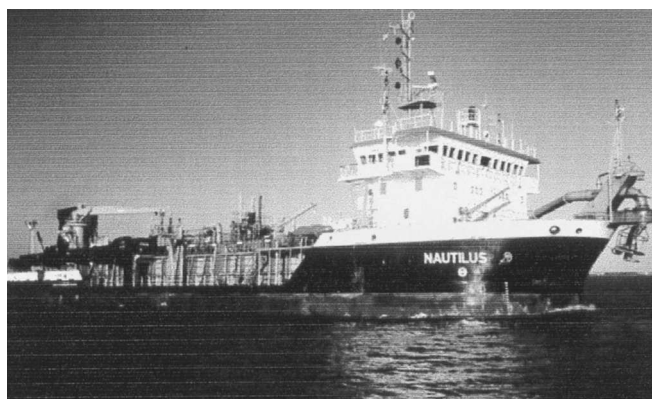
LÁM. I. Draga de succión en marcha Nautilus
