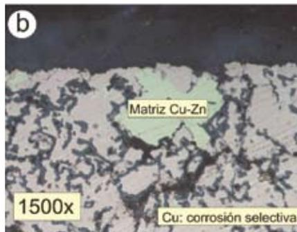
(a) Imagen a microscopía óptica de la cara posterior de una muestra del grupo 1, previa al ataque metalográfico (300x). (b) Detalle de zona de corrosión selectiva rica en cobre con restos de matriz (1500x). Fuente: Departamento de Ciencia de los Materiales e Ingeniería Metalúrgica y Química Inorgánica. Universidad de Cádiz
