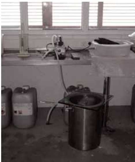
➤ Cámara de vacío, bomba de vacío, manómetro manual y digital / ANA BOUZAS ABAD, IAPH
