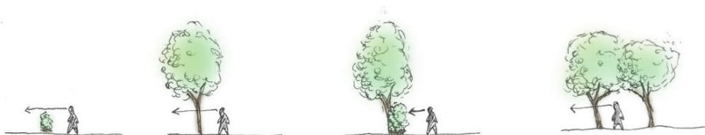
Figur 1 - Påvisar hur ögonhöjdsanalys utförs i praktiken. Figuren visar följande växtelement från vänster till höger – häck, ensamt träd, tät växtvägg i form av hög häck, krontak. Illustration: Lisa Erséus
