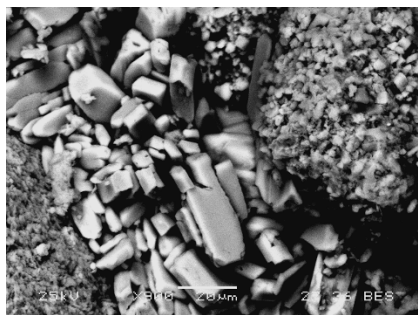
fig 5. Sales de carbonato de K creciente bajo la capa de tratamiento (SEM).
