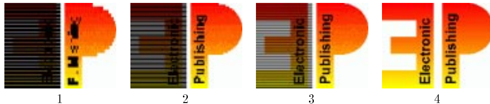
Abbildung 2.7: Die Stufen des GIF Interlace Schemas
