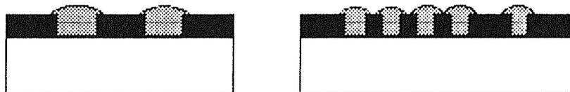
Abb. 4: Die Skizzen zeigen zur Verdeutlichung der Ausführungen im Text Resiststrukturen (schwarz) als Komplementärstrukturen der Schlitzaperturen, die durch elektrolytische Abscheidung von Metall (grau) auf dem elektrisch leitenden Substrat gerade übergalvanisiert werden. Bei kleinen Schlitzbreiten, d. h. bei schmalen Resiststrukturen (rechts), besteht die Gefahr, daß der galvanische Niederschlag über den Resiststrukturen zusammenwächst.
