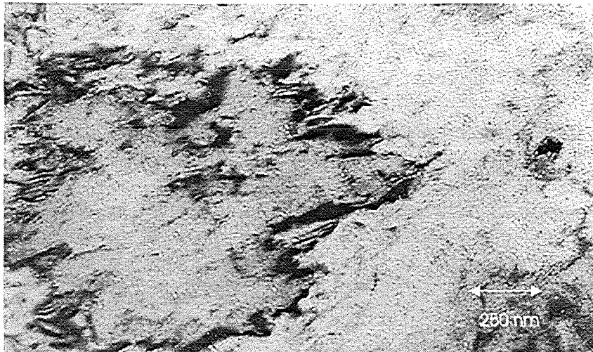
Abb. 5.60: Heliumblasen in vorbestrahltem F82H-mod. waren nur in wenigen TEM-Proben zu finden. Diese Aufnahme ist daher nicht als repräsentativ anzusehen. Heliumdosis 400 appm He, T_{\text{Bestr.}}=250^{\circ}\text{C} und T_{\text{Test}}=200^{\circ}\text{C} , \Delta\varepsilon_{\text{total}}=0,9\% , d\varepsilon/dt=8\cdot 10^{-4}\text{ s}^{-1} .
