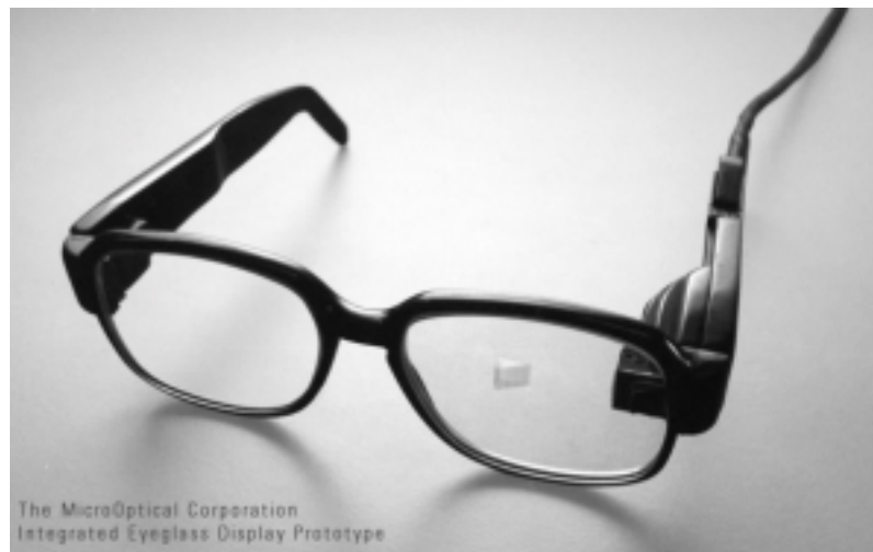
Abbildung 1: Microdisplay von MicroOptical
