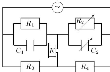
Die unbekannte Kapazität  $C_1$  und der unbekannte Widerstand  $R_1$  können mit Hilfe der o. a. Schaltung bestimmt werden. Man variiert dazu den Kondensator  $C_2$  und den Widerstand  $R_2$  solange, bis der Ton im Lautsprecher  $K$  ein Minimum erreicht oder verschwindet. In diesem Fall gilt
