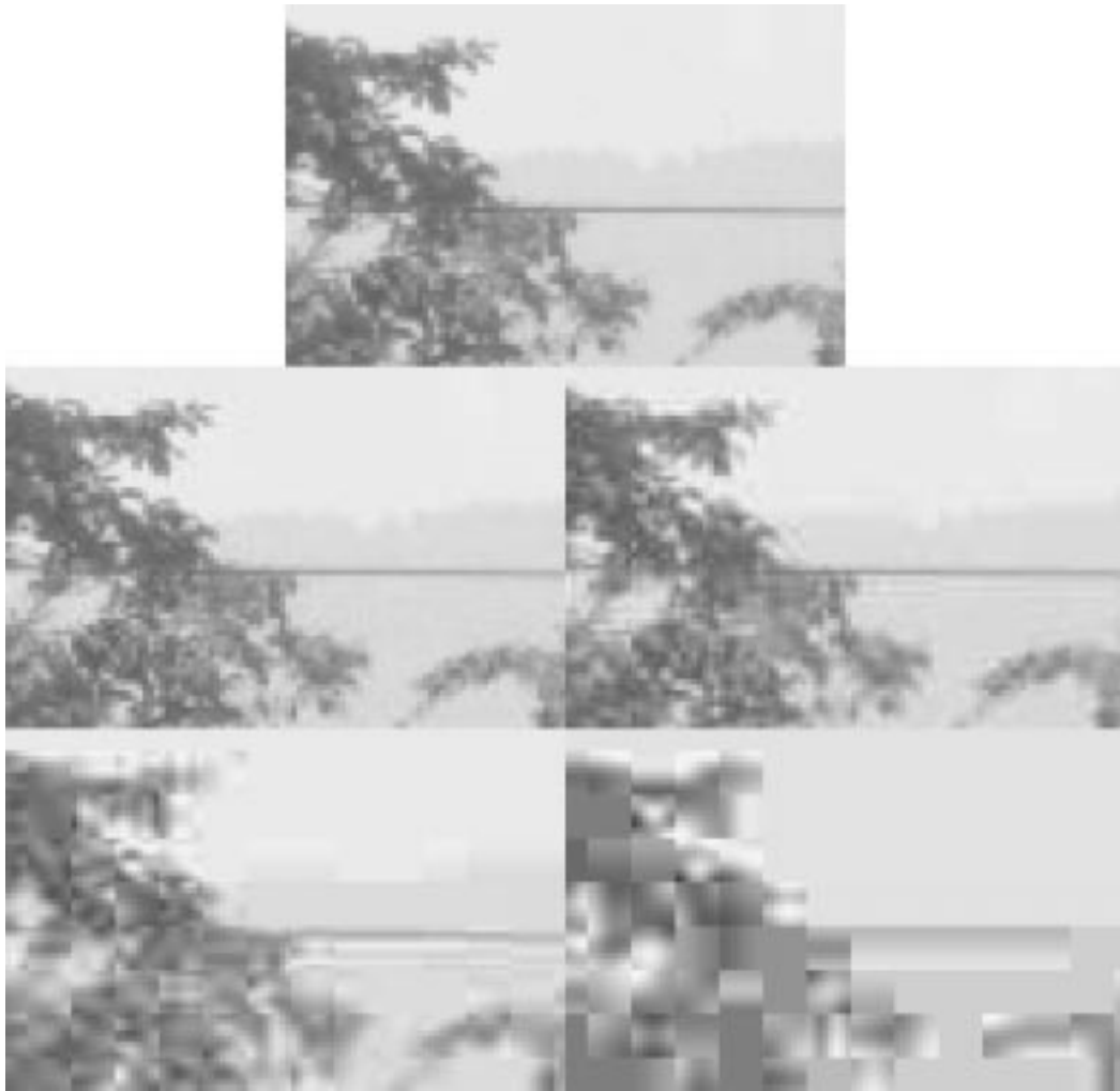
Abbildung 16: Ausschnitte aus Bild 15. Oben ein Teil des Originals — darunter Ausschnitte des Bildes nach Kompression auf 1/10 (mitte links), 1/20 (mitte rechts), 1/50 (unten links) und 1/100 (unten rechts) der Originalgröße
