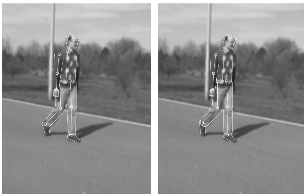
Abbildung 3.13: Modellanpassungen von Versuch 33 (links) und Versuch 38 (rechts) zum Halbbildzeitpunkt 53. Dargestellt sind die tiefpaßgefilterten Halbbilder mit dem angepaßten Modell.
