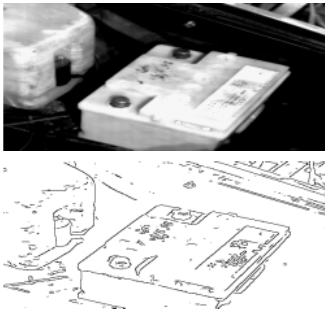
Abbildung 1.3: Kantenelementbild (unten) zu einer Aufnahme der Autobatterie (oben). Die Gradientenrichtungen der Kantenelemente sind in den jeweils gesetzten Pixeln kodiert. Aus Zeitgründen werden bei der Verfolgung stets Halbbilder, keine Vollbilder verwendet.
