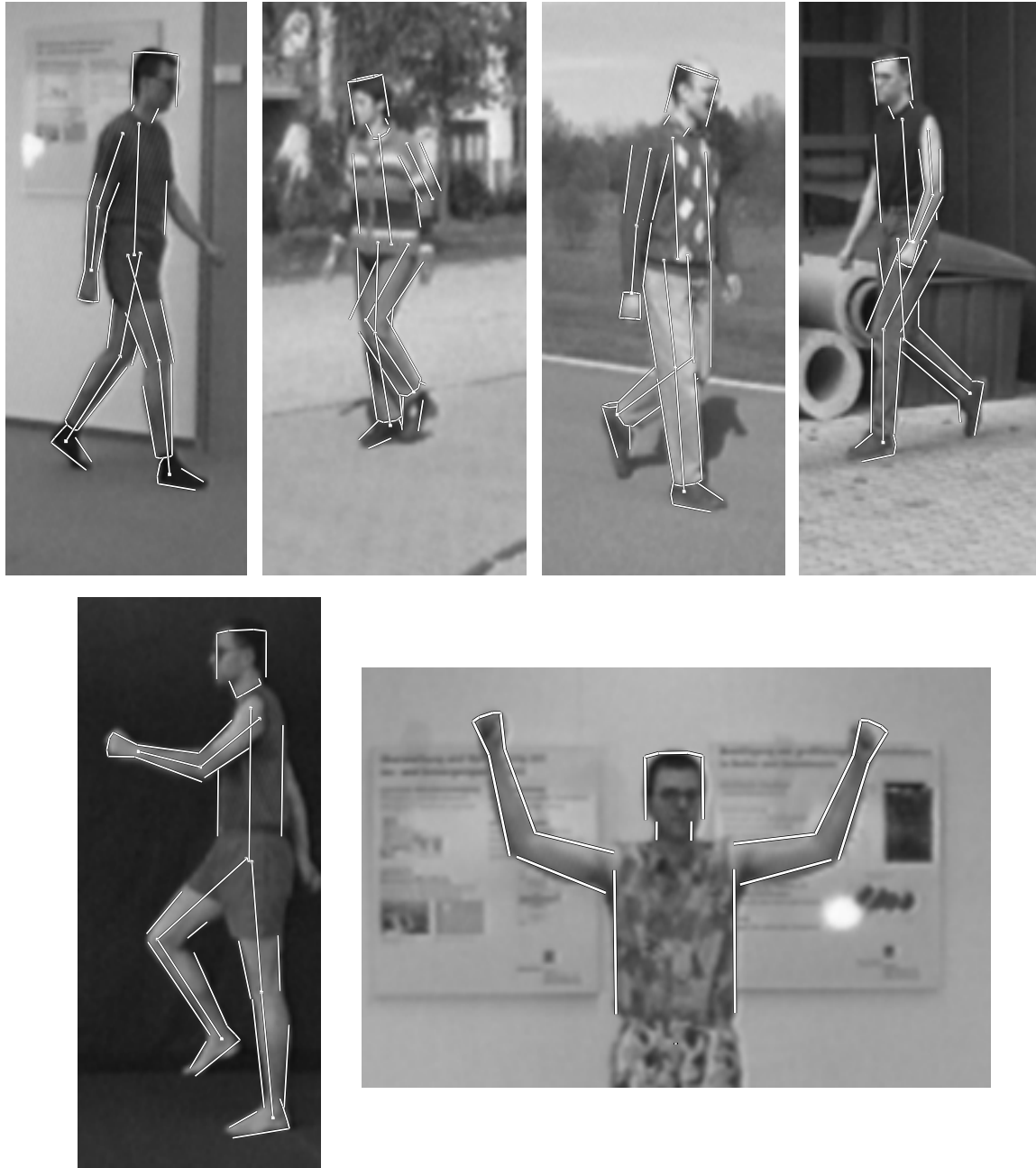
Abbildung 1.1: Referenzversuche: Verfolgung bei den sechs Bildfolgen nach [Wachter 97]. Bildfolgennamen und Halbbildzeitpunkte zur Bilderreihe oben, v.l.n.r.: l_rot (Halbbild 91), alinde (Halbbild 67), frankm (Halbb. 148) und hof_191096 (Halbb. 129). Unten: s1_191096 (Halbbild 47) (links) sowie g_braun (Halbbild 100) (rechts).
