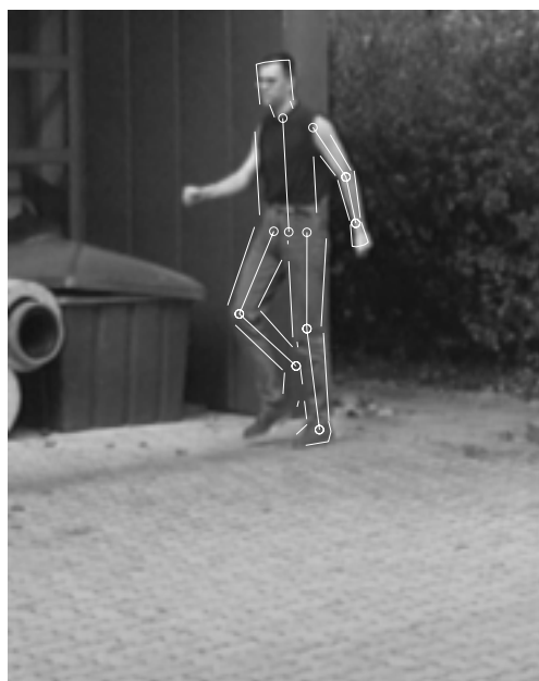
Abbildung 3.10: Modellanpassung bei einer Verfolgung zu hof_191096 zum Halbbildzeitpunkt 79. Es entsteht ein Verfolgungsproblem aufgrund des niedrigen Kontrasts zwischen den Beinen und dem Hintergrund. Dargestellt sind die tiefpaßgefilterten Halbbilder mit dem angepaßten Modell.
