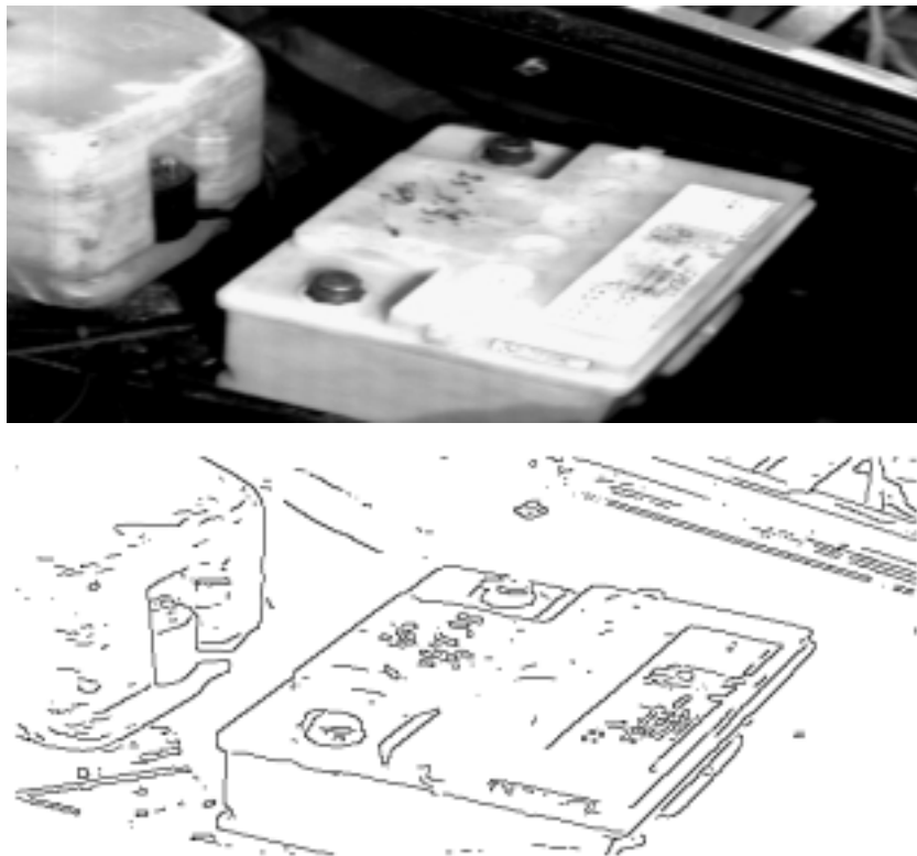
Abbildung 4.9: Bild der Autobatterie (oben) und extrahierte Kantelemente bei Verwendung der Maskenberechnung mittels Abtastung einer abgeleiteten Gaußfunktion und der Maskenberechnung mit Randausgleich nach [Otte 94] (unten) bei einer Filterung mit konstanten Masken.
