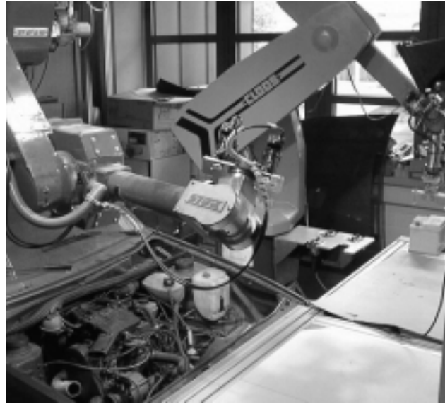
Abbildung 1.2: Versuchsumgebung Roboterzelle. Man kann den Beobachtungsroboter auf der linken Seite erkennen und den werkzeugtragenden Roboter im hinteren rechten Teil des Bildes.
