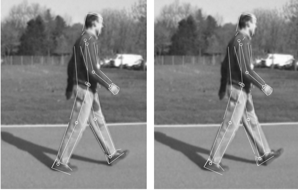
Abbildung 3.5: Modellanpassungen bei frankm zu den Halbbildzeitpunkten 281 (links) und 282 (rechts). Das linke Modellbein bewegt sich plötzlich unerwartet rückwärts trotz fortgesetzter Vorwärtsbewegung des linken Bildbeins. Dargestellt sind die tiefpaßgefilterten Halbbilder mit dem angepaßten Modell.
