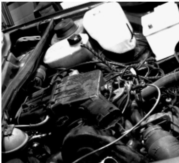
Abbildung 4.19: Blick in den Motorraum des Versuchsfahrzeugs. Der kugelförmige Unterdruckbehälter für die Servolenkung ist im Bild in der linken, unteren Ecke zu sehen. In der rechten, oberen Ecke des Bildes kann man die Batterie erkennen und etwa in der Mitte des Bildes befindet sich der Luftfilter.
