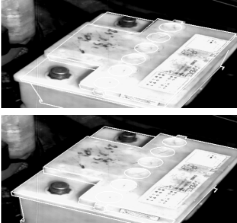
Abbildung 4.13: Verfolgung der Autobatterie zum Halbbildzeitpunkt 201 bei der bisherigen Bildfilterung mit ortsinvarianten Filtermasken (oben) und der adaptiven Bildfilterung nach (4.9), (4.10) mit x_{\min} = 10 , x_{\max} = 11 (unten) bei einer Schwelle für den Minimalabstand projizierter Modellkanten von 2,75 Pixel.
