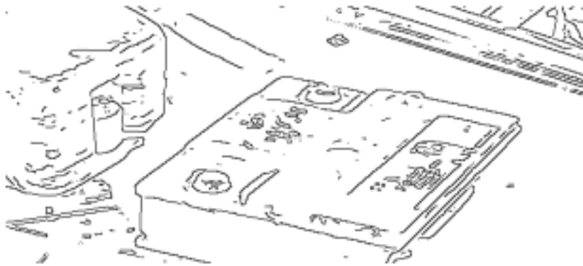
Abbildung 4.10: Adaptive Bildfilterung mit Eigenwerttransformation nach den Gleichungen (4.4) und (4.6). Im rechten Teil der Batterie kann man gegenüber dem unteren Teil von Abbildung 4.9 eine deutlich bessere Auflösung der parallelen Bildkanten erkennen.
