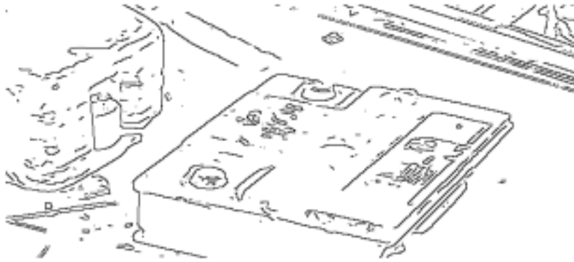
Abbildung 4.11: Adaptive Bildfilterung mit Eigenwerttransformation nach den Gleichungen (4.7) und (4.8). Insbesondere die parallelen Bildkanten im rechten Teil der Batterie werden im Vergleich zu Abbildung 4.10 deutlich besser aufgelöst.
