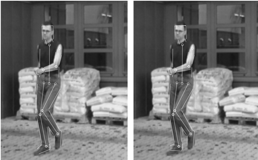
Abbildung 3.14: Modellanpassungen von Versuch 43 (links, \text{Zylinderenden komplett} = \text{nein} ) und Versuch 68 (rechts, \text{Zylinderenden komplett} = \text{ja} ) zum Halbbildzeitpunkt 462 zur Demonstration der Wirkung des Parameters \text{Zylinderenden komplett} auf die Projektion der linken Modellhand bei hof_191096 . Der Parameter beeinflusst auch das Aussehen der Fußmodelle im Fersenbereich, was in der Abbildung allerdings nicht sichtbar ist. Dadurch entsteht die unterschiedliche Anpassung des rechten Fußes aufgrund der unterschiedlichen zeitlichen Entwicklung der beiden Versuche.
