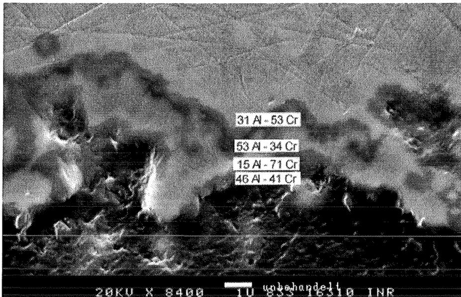
Abbildung 85: Aufbau der Oxidschicht auf einer mechanisch geglätteten und wärmebehandelten Probe nach 200 h Oxidation bei 950 °C.
