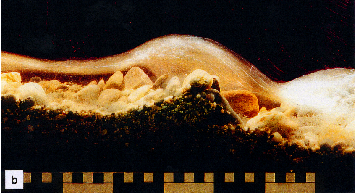
Abb. 3.11: Strömungsverhältnisse über einer Absturz-Becken Sequenz. Die Aufnahme wurde innerhalb der Untersuchungen von ROSPORT (1997) am Institut für Wasserwirtschaft und Kulturtechnik der Universität Karlsruhe gemacht
