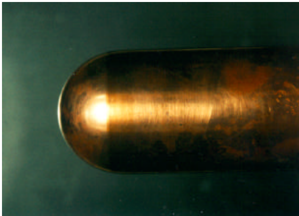
(a) Keine Kavitation, hohe Zerreifestigkeit des Wassers. U_\infty = 11\text{m/s} , \sigma_\infty = 0.43
