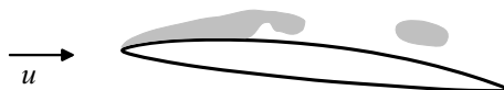
Abbildung 2.4.: Instationäres Aufbrechen der Schicht kavitation durch den Re-entrant Jet, \sigma = \sigma_3 > \sigma_2 .
