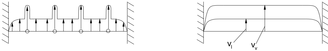
Abbildung 2.16.: Geschwindigkeitsprofil in der Realität und beim Zweifluidmodell am Beispiel einer zweiphasigen Kanalströmung [69].
