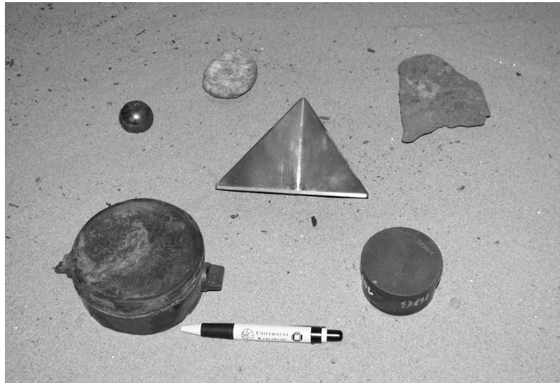
Bild 7.11: Szenario aus sechs Zielen. Von vorne links nach hinten rechts: PMN-1 APM, PRB-M35 APM, Dreiflächenreflektor (10 cm Kantenlänge), metallische Kugel mit 3,6 cm Durchmesser, Kiesel, Sandstein.
