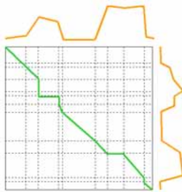
Abbildung 6.6: Grauwertmatching mit dynamischer Programmierung
