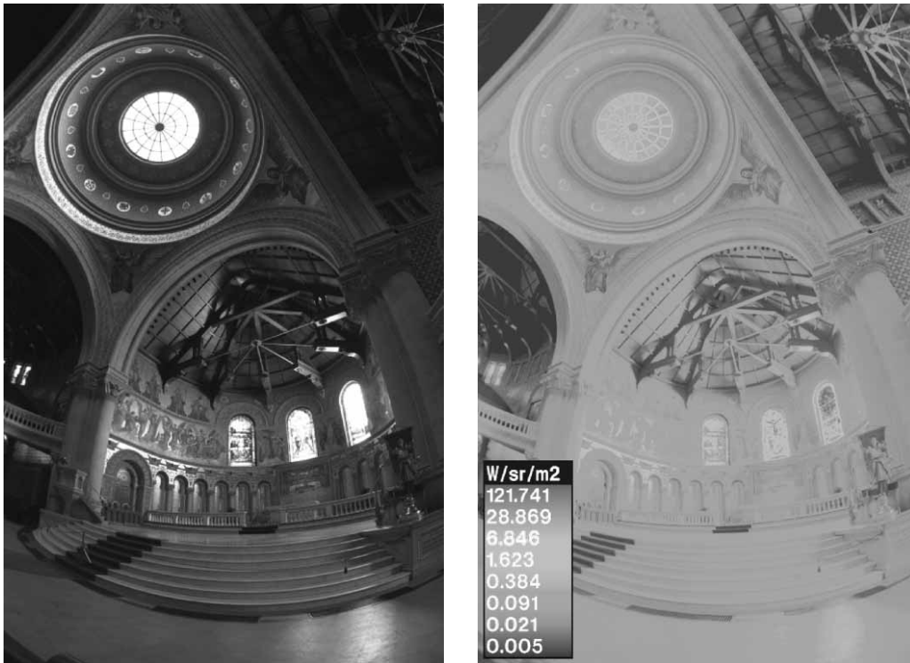
Abbildung 8.12: links: Bestmöglich belichtetes Einzelfoto. Helle und dunkle Zonen sind trotzdem schwarz bzw. weiss gesättigt. Die Fenster sprossen sind ausgeblutet. rechts: Falschfarbendarstellung des Bildes mit hohem Dynamikbereich. Jeder Dynamikbereich besitzt seine Details. Entnommen aus [Debevec & Malik '97]
