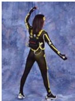
**Abbildung 8.10:** Magnetische Ganzkörpererfassung
