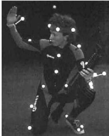
**Abbildung 8.11:** Markerbasiertes optisches Verfahren
