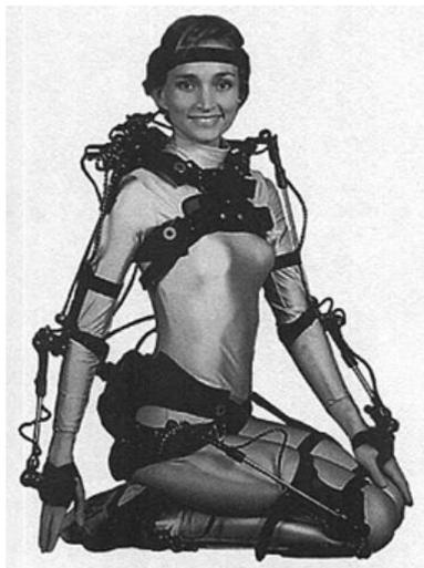
**Abbildung 8.8:** Elektromechanisches Exoskelet
