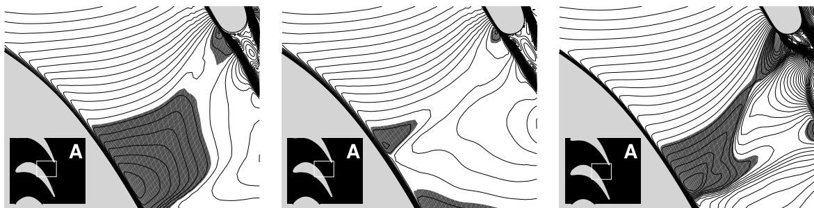
Abbildung 6.29.: Vergleich der Verteilungen der gefrorenen Machzahl M_f im Hinterkantenbereich des Rotors; grau: M_f > 1 , Inkrement: \Delta M_f = 0.02 ; links: Strömung ohne Wärmezufuhr, Mitte: rein homogen kondensierende Strömung, rechts: dominierend heterogen kondensierende, thermisch blockierte Strömung; Detail A: vergrößerter Ausschnitt innerhalb des Rotorgitters;
