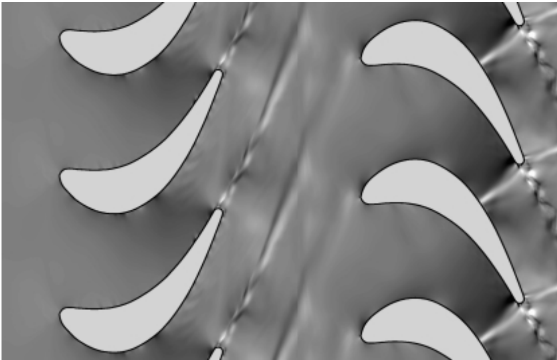
Abbildung 6.21.: Numerisch simuliertes Schlierenbild der homogen kondensierenden Strömung in der Stufe VKI-1, Schlierenkante senkrecht zur lokalen Gitterausrichtung, physikalische Größen: p_{01} = 0.417 bar, T_{01} = 357.5 K, \beta_{1,1} = 120^\circ , \bar{p}_{2,2} = 0.194 bar, Re_{2,2} = 1.15 \times 10^6 , M_{2,2,is} = 1.13 , |u| = 175 m/s, Frequenzen: f_{rs} = 2.46 kHz, f_{vs,Stator} = 11.6 kHz, f_{vs,Rotor} = 16.2 kHz;
