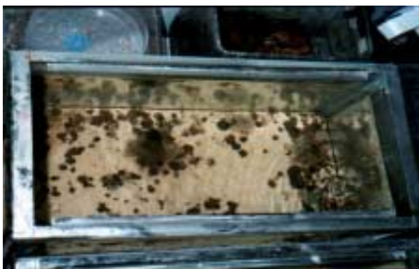
Abb. 3.1.1a: 1 cm hohe Barriere 1 Monat nach Aufbringung (Aufsicht).
