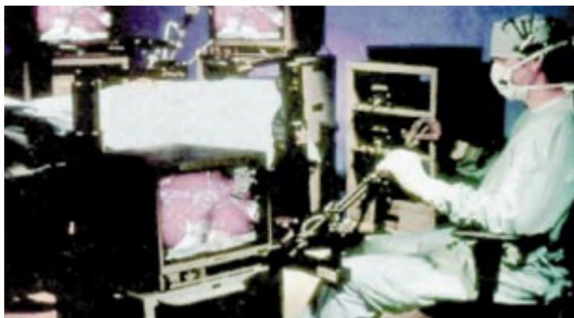
Abb. 7: Chirurgischer Arbeitsplatz ZEUS der Fa. Computer Motion.
