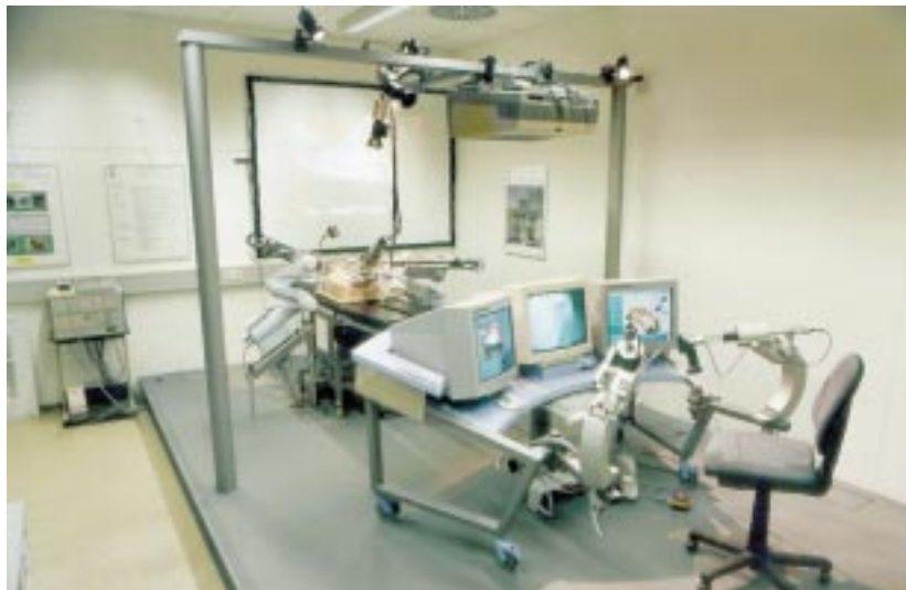
Abb. 9: Experimenteller Operationssaal ARTEMIS mit dem Bediensystem im Vordergrund und dem Operationstisch mit dem Arbeitssystem im Hintergrund.
