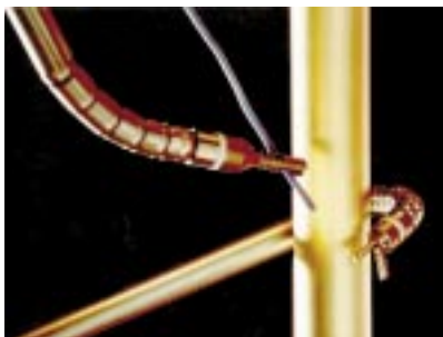
Abb. 2 zeigt als Beispiel ein flexibles Instrument, mit dessen steuerbarem vorderem Ende die Umfahrung von Organen möglich ist.
