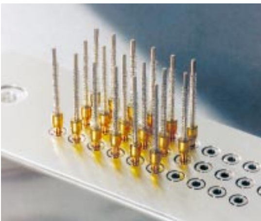
Abb. 6: Foto der Bestrahlungsplattform für den BX-Stent unseres Industriepartners IsoStent. Diese Plattform wird horizontal durch den Strahl bewegt, damit alle Stents gleichmäßig aktiviert werden.
