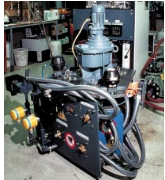
Abb. 3: Seitenansicht des auf Permanentmagneten basierenden Karussell-Magnetseparators KMP3.
