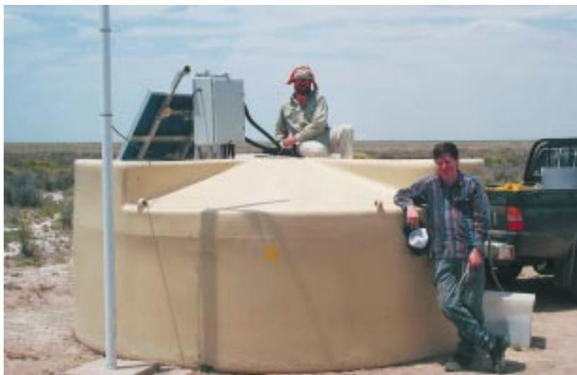
**Abb. 2:** Installationsarbeiten an einem Detektortank des Prototyparrays.
