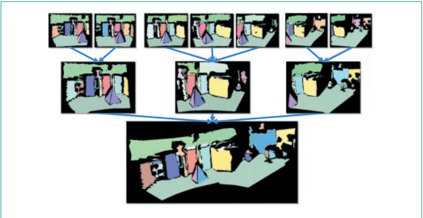
Abb. 5: Verschmelzung einer Sequenz aus sieben segmentierten Oberflächenmodellen eines Laborinnenraums. Die zugehörigen Aufnahmepositionen des Fahrzeugs sind unbekannt.
