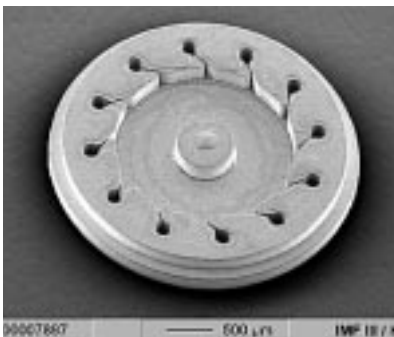
Abb. 7: Turbinengehäuse aus ZrO_2 -Keramik, hergestellt durch Niederdruck-Keramik-Spritzgießen (LP-CIM).
