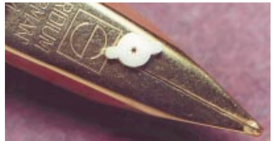
Abb. 4: Mikro-Zahnrad-Form aus ZrO 2 -Keramik, 500 µm hoch, hergestellt durch Hochdruck-Keramik-Spritzgießen (HP-CIM): der Zahnkopfdurchmesser beträgt 480 µm, die minimale Zahnbreite ca. 70 µm.
