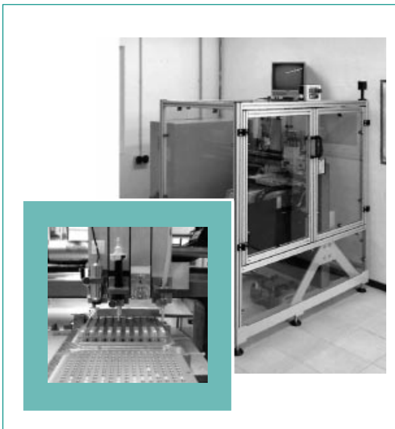
Abb. 5: Realisierte Maschine zur Montage von mikrofluidischen Analysesystemen.
