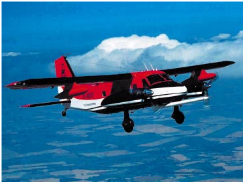
Abb. 1: Das Forschungsflugzeug DO128, Rufzeichen D-IBUF: An der Spitze des Nasenmastes befinden sich Sensoren für die Messung der meteorologischen Parameter Wind, Temperatur und Feuchte.
