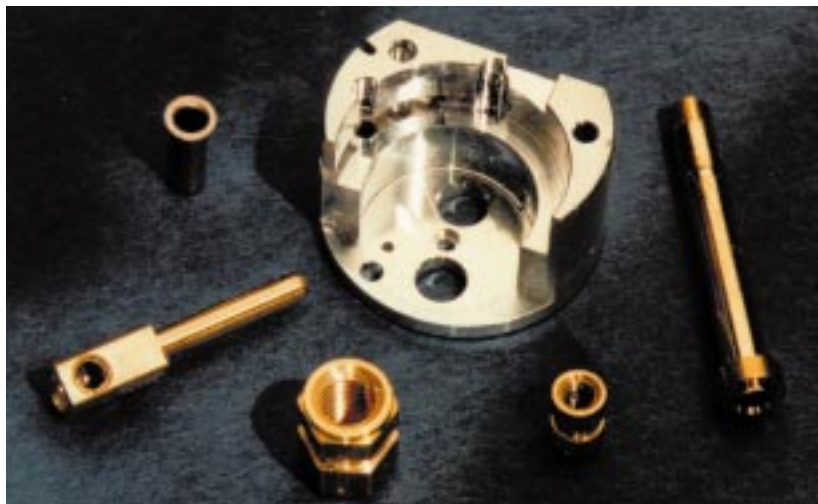
Abb. 3: Auswahl an Teilen zur Reinigung mit Kohlendioxid.
