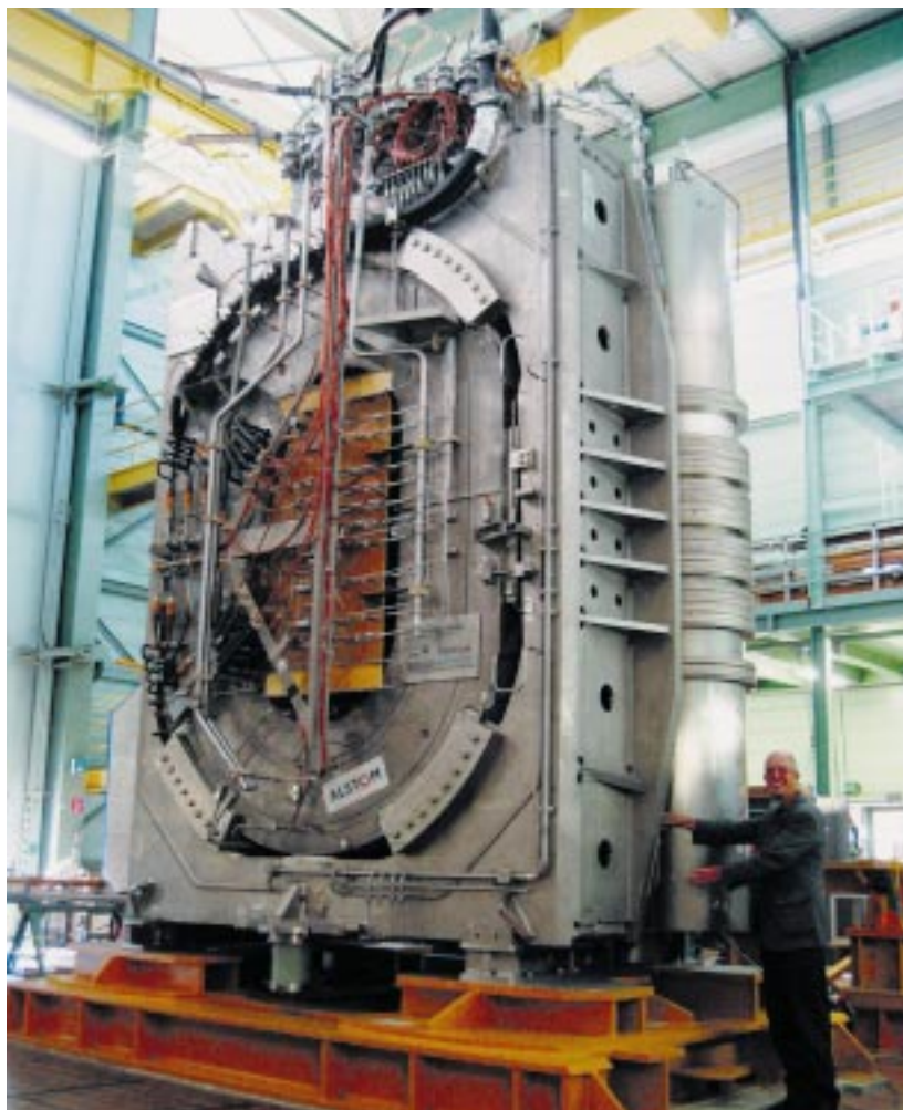
Abb. 2: Die TFMC in ihrem Zwischenrahmen. Auf der rechten Seite ist gerade noch ein Teil der LCT Spule zu sehen.
