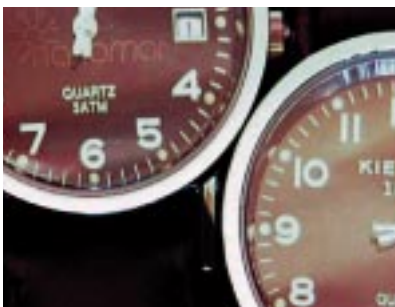
Abb 6: Links entspiegeltes Uhrenglas mit dem neuartigen Antireflexwasserzeichen. Nur das LOGO reflektiert wie die zum Vergleich nicht entspiegelte Uhr rechts.
