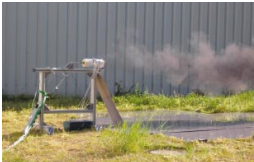
Abb. 5: Versagenstest eines mit Ti-dotiertem, nanoskaligem \text{NaAlH}_4 gefüllten Wärmetauscherrohr.
