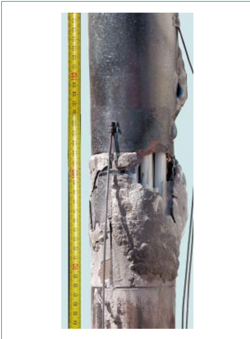
Abb. 3: QUENCH-Bündel nach dem Versuch: Heißester Bereich mit oxidierten Brennstabhüllrohren und teilweise geschmolzenem Dampfführungsrohr.
