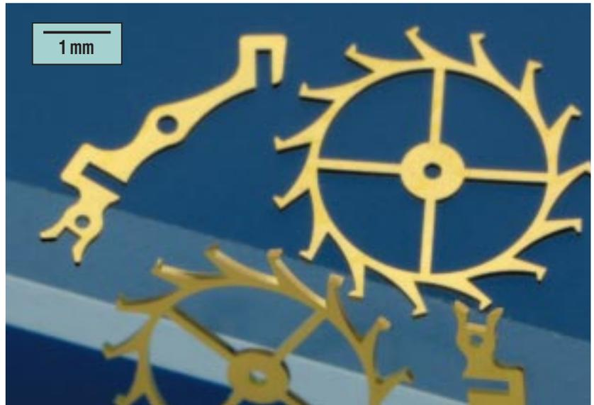
**Abb. 4:** Anker und Zahnrad aus hartem Gold für mechanische Uhrwerke werden im Forschungszentrum Karlsruhe mit dem LIGA-Verfahren so präzise hergestellt, dass keine Schmierung mehr erforderlich ist.
