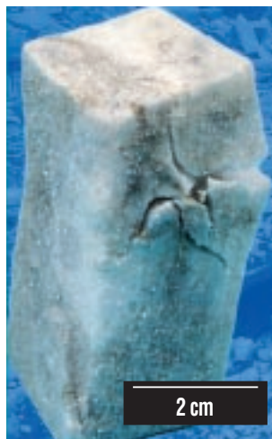
Abb. 4: Reproduktion der „Zwergelöcher“ im Labor.
