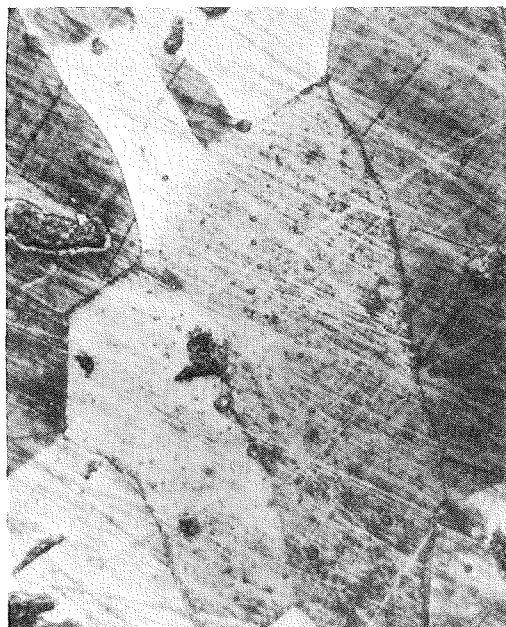
Abb. 40: Gefügeaufnahme von \text{ThC}_{0,45}\text{N}_{0,55}
