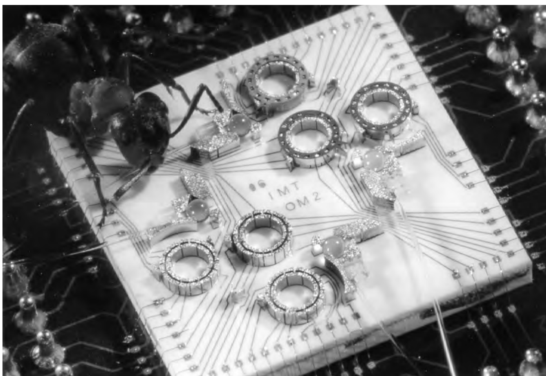
Abbildung 4.35: Fotografie einer vollständig bestückten und kontaktierten Schaltmatrix mit einer Ameise als Größenvergleich; Abmessungen des Keramiksubstrates: ca. 10 \times 10 \text{ mm}^2 , Höhe der Nickelstrukturen 400 \mu\text{m}
