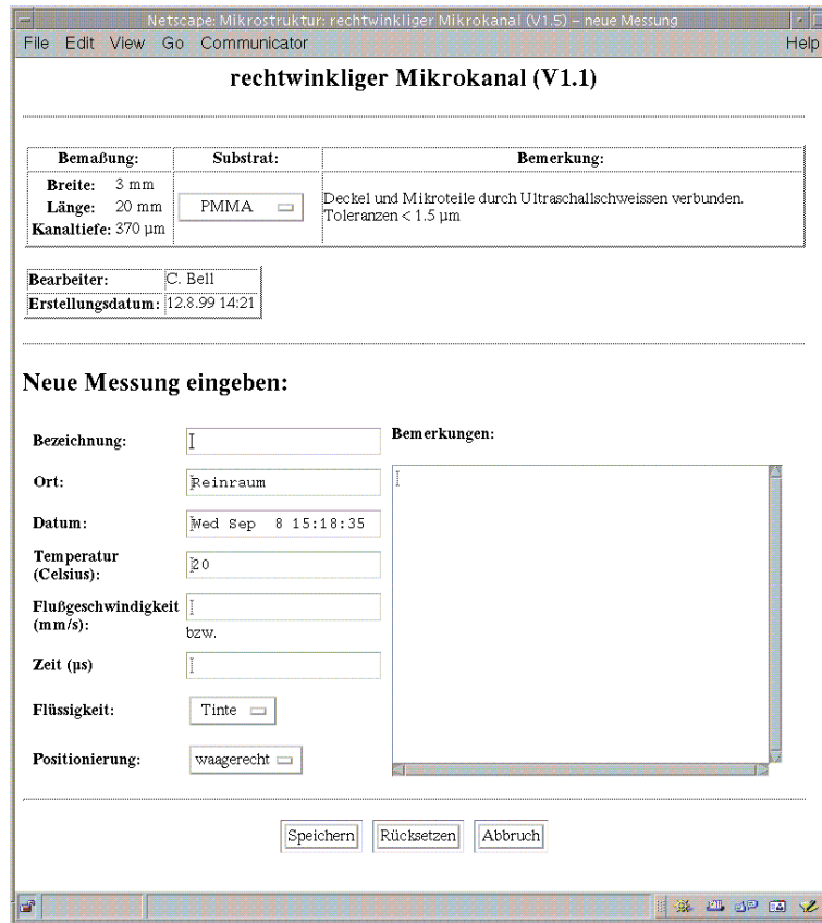
Abbildung 5.5: WWW Schnittstelle zum Versuchscontainer
