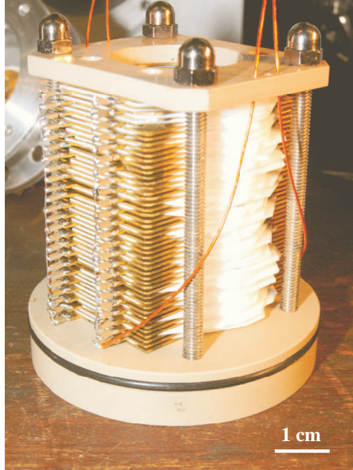
Abbildung 17: Fotografie des Ionenrichters.
