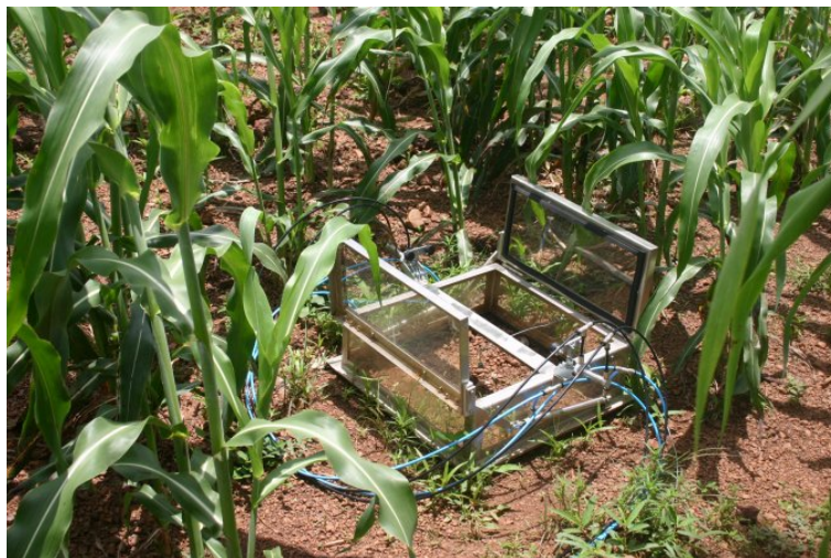
Pneumatisch betriebene Kammern
