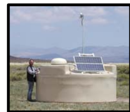
1660 Oberflächen Detektoren: Wassertanks-Cherenkov Im Grid von 1.5 km
