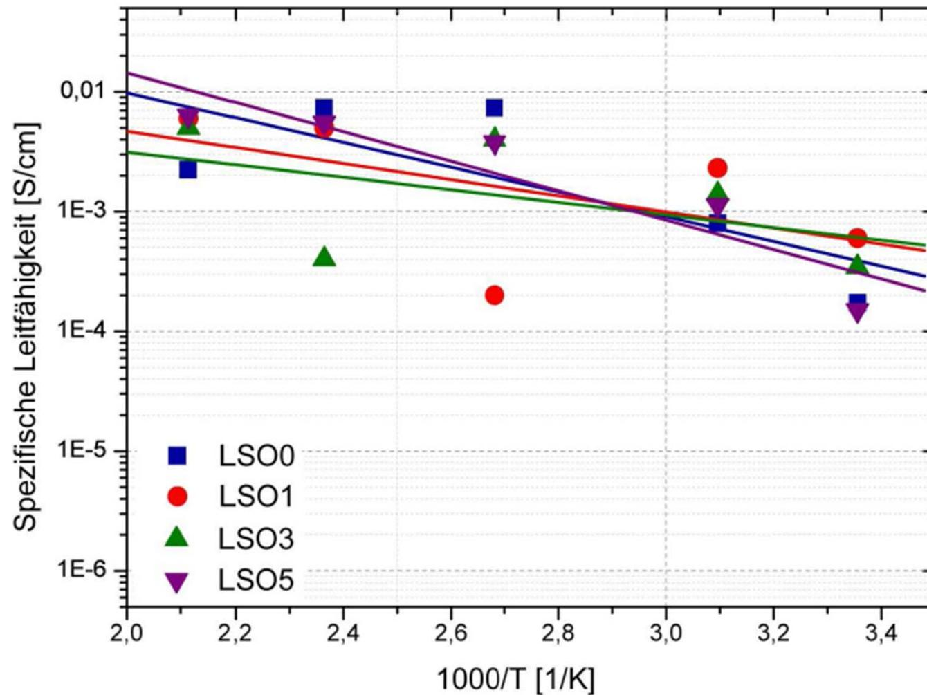
⇒ Zusatz von  $\text{Li}_4\text{SiO}_4$  hat keinen Einfluss auf Ionenleitfähigkeit
