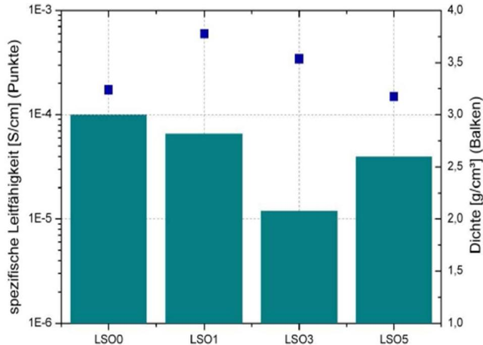
Dichte und Leitfähigkeit der mit einer Haltezeit von 15 Minuten lasergesinterten LAGP V28 Proben mit unterschiedlicher LSO- Konzentration.
