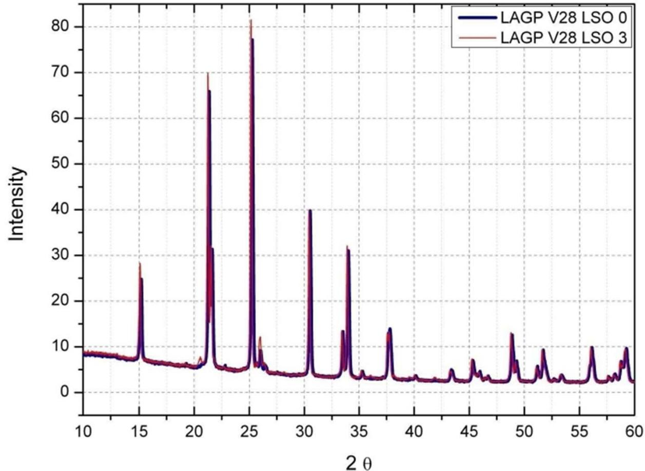
Vergleich der Röntgendiffraktogramme einer mit einer Sinterzeit von 15 Minuten laser-gesinterten reinen LAGP V28 Probe und einer LAGP V28 LSO3 Probe
