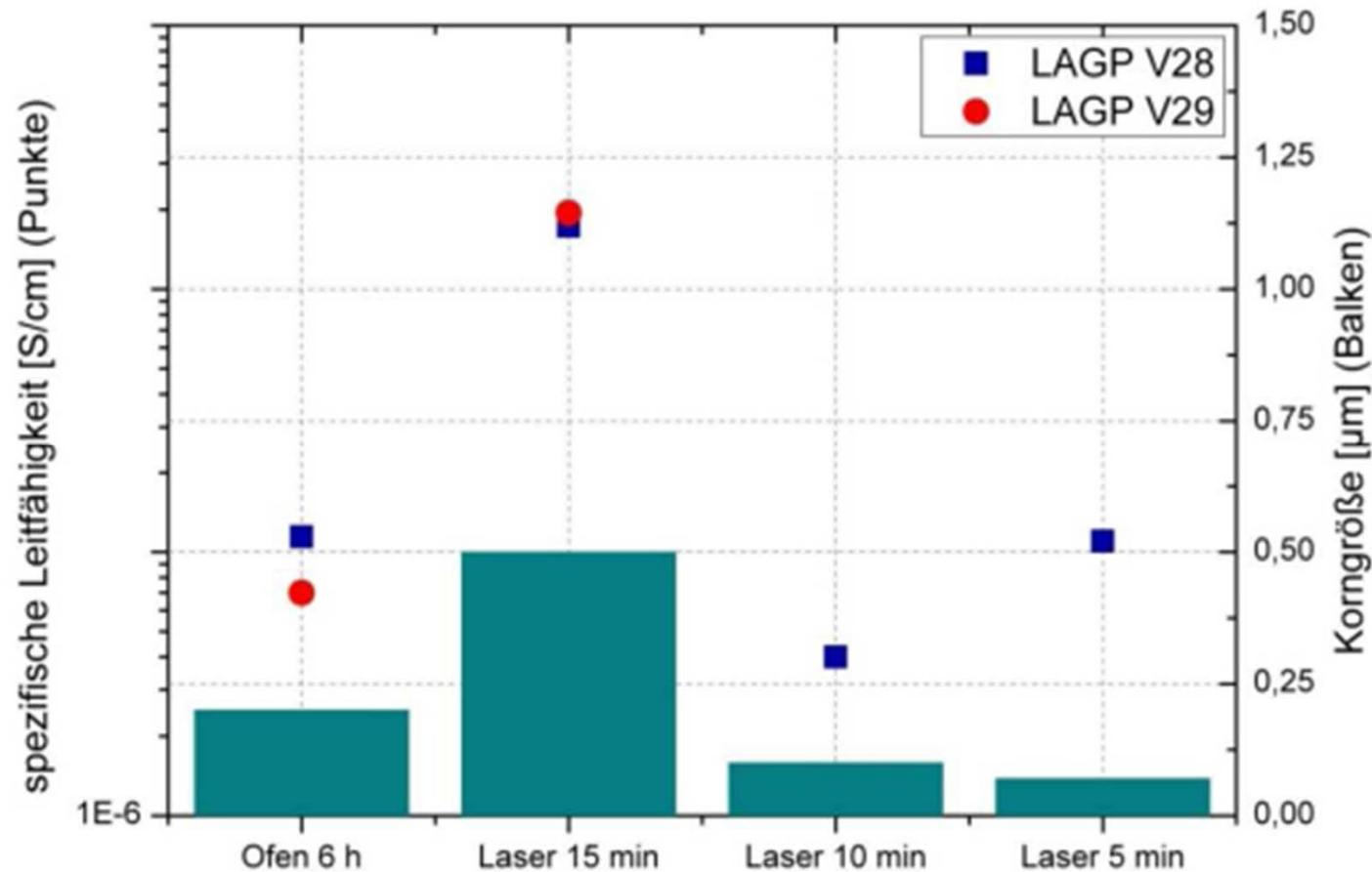
*Ionenleitfähigkeit und Korngröße der durch unterschiedliche Sinterfahren hergestellten LAGP V28 LS00 und LAGP V29 LS00 Proben*
