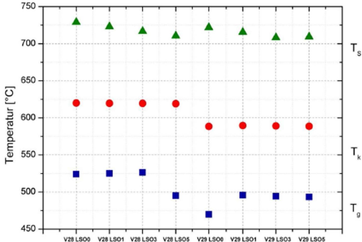
Grafische Darstellung der Glasübergangstemperatur ( $T_g$ ), Kristallisierungstemperatur ( $T_c$ ) und Schmelztemperatur ( $T_s$ ) bei den unterschiedlichen Pulvermischungen.
