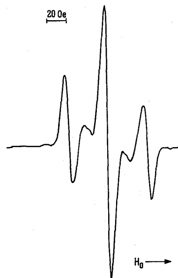
Abb. 2. ESR-Spektrum des bestrahlten Einkristalls von Adenosin Hydrochlorid. Das Magnetfeld liegt parallel zur x -Achse.
