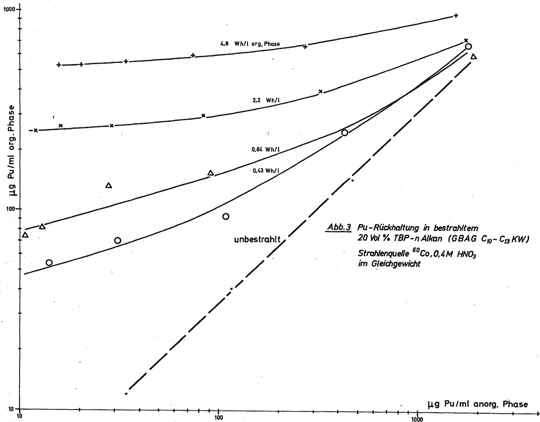
**Abb.3** Pu-Rückhaltung in bestrahltem
