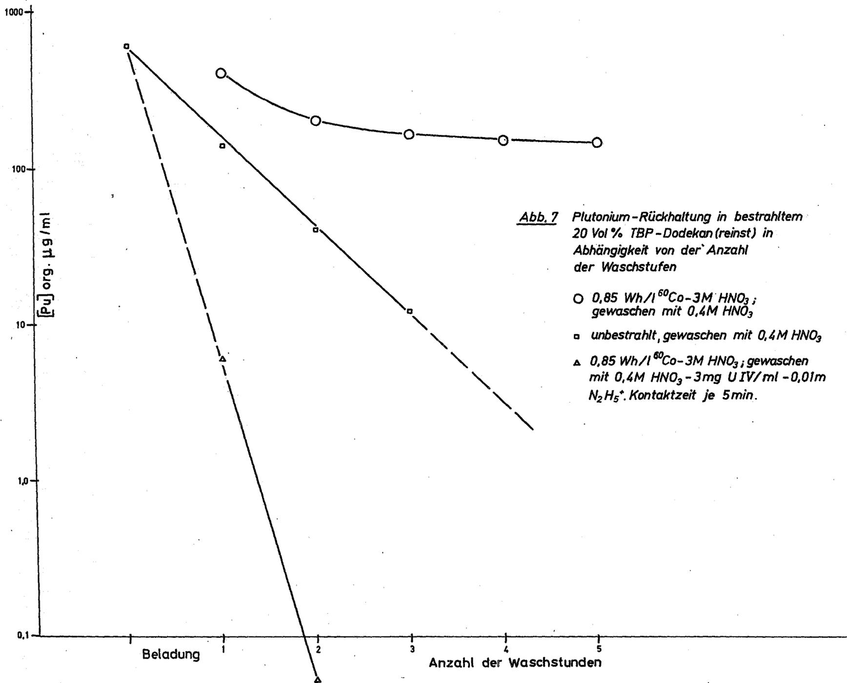
**Abb. 7** Plutonium-Rückhaltung in bestrahltem 20 Vol % TBP-Dodekan (reinst) in Abhängigkeit von der Anzahl der Waschstufen
