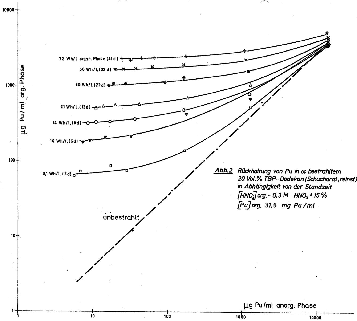
**Abb.2** Rückhaltung von Pu in  $\alpha$  bestrahltem
