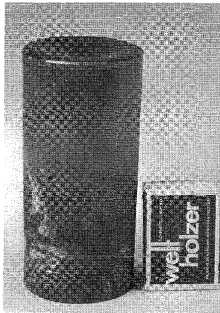
Abb. 24 Glasblock aus der Labor-Verglasungsanlage
