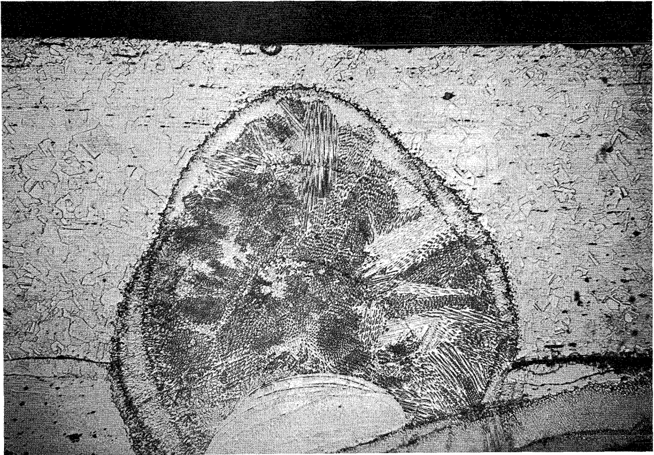
Bild 3 Mikroskopisches Gefügebild (V = 200x) einer Elektronenstrahl-Schweißnaht: Befestigungsmuffe - Mantel - thermoelement
