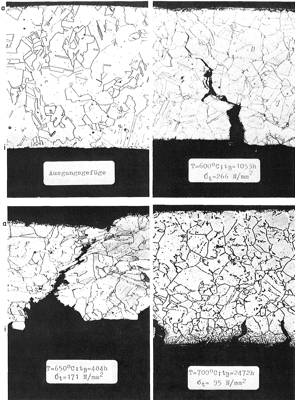
Abb.62 Austenitischer Stahl X10NiCr3220 Werkstoff-Nr. 1.4861
