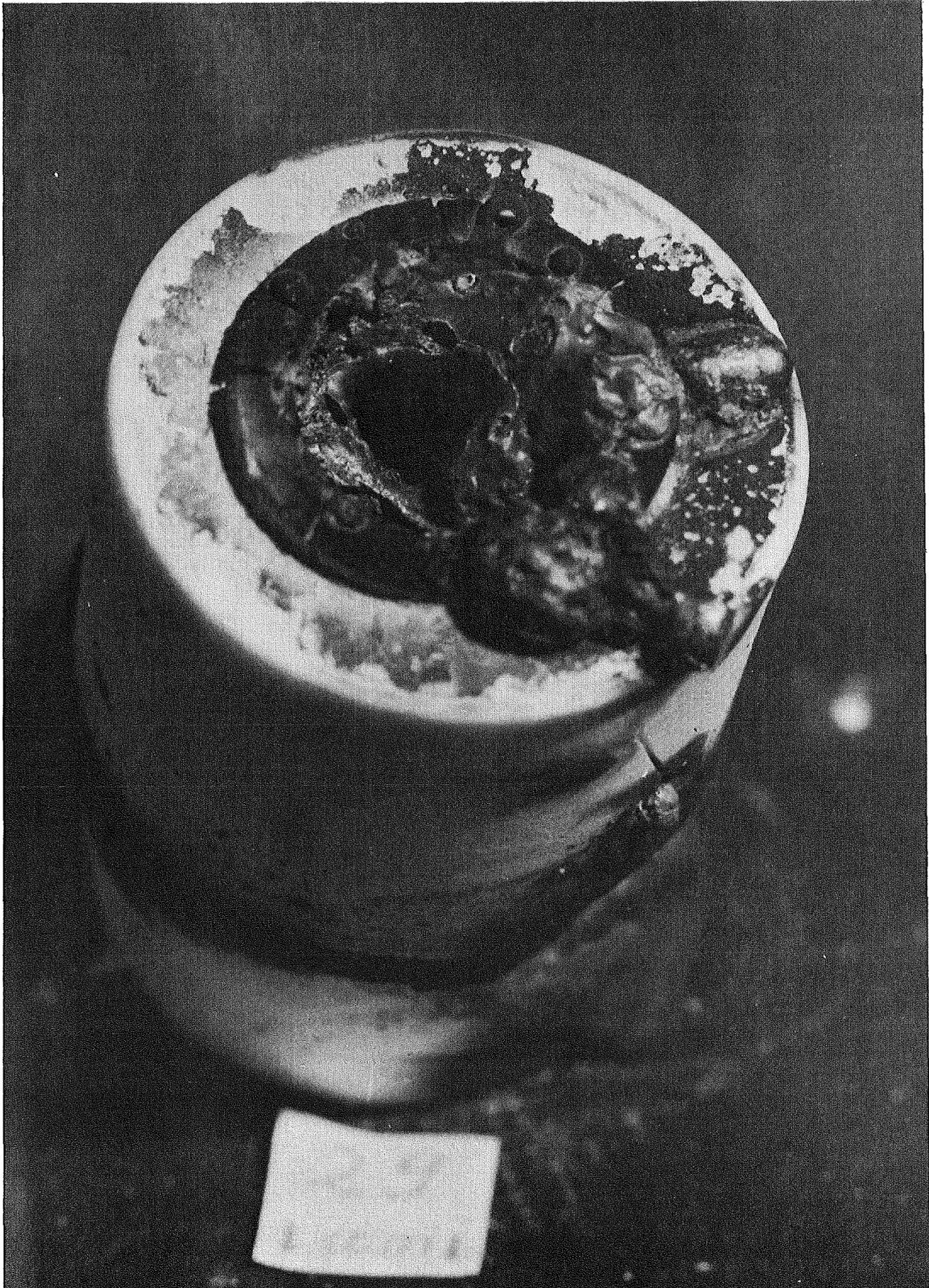
Abbildung 11: Beispiel für eine Krustenbildung des Schmelzgutes am oberen Tiegelrand
