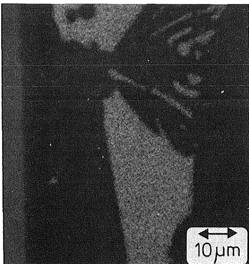
Abb. 37: Mikroanalytische Charakterisierung von Phasen in abgeschmolzenen Stäben. Stelle zwischen UO_2 -Zone und innerer Randschicht
